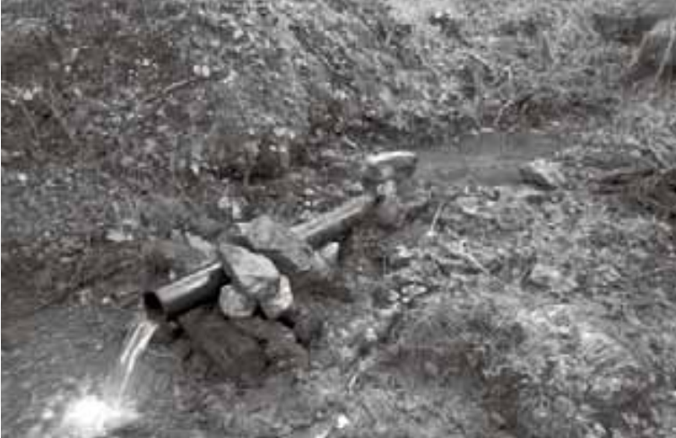
Wasservorkommen E: Provisorischer Messtelle eingerichtet
